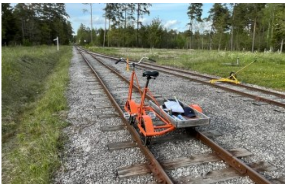
28 maj. Besiktning av spåren på Tule station med bandressinen och mättralla.
